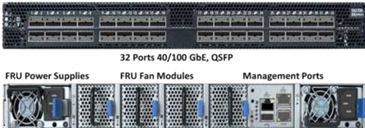
Figura 4. Interruptor SN2700 delantero y trasero
