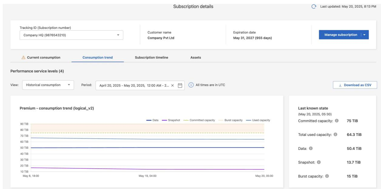
El gráfico de líneas muestra datos históricos de consumo y permite a los usuarios analizar tendencias durante un rango de fechas seleccionado. El gráfico muestra métricas como datos (capacidad de almacenamiento utilizada por los datos del usuario), instantáneas (capacidad de almacenamiento
