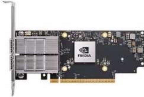
El adaptador NVIDIA ConnectX-7 puede proporcionar 25/50/100/200/400G de rendimiento. Los sistemas NVIDIA DGX utilizan los adaptadores ConnectX-7 de puerto único o doble para proporcionar flexibilidad en puestas en marcha de DGX BasePOD con InfiniBand y Ethernet de 400GB Gb/s.
