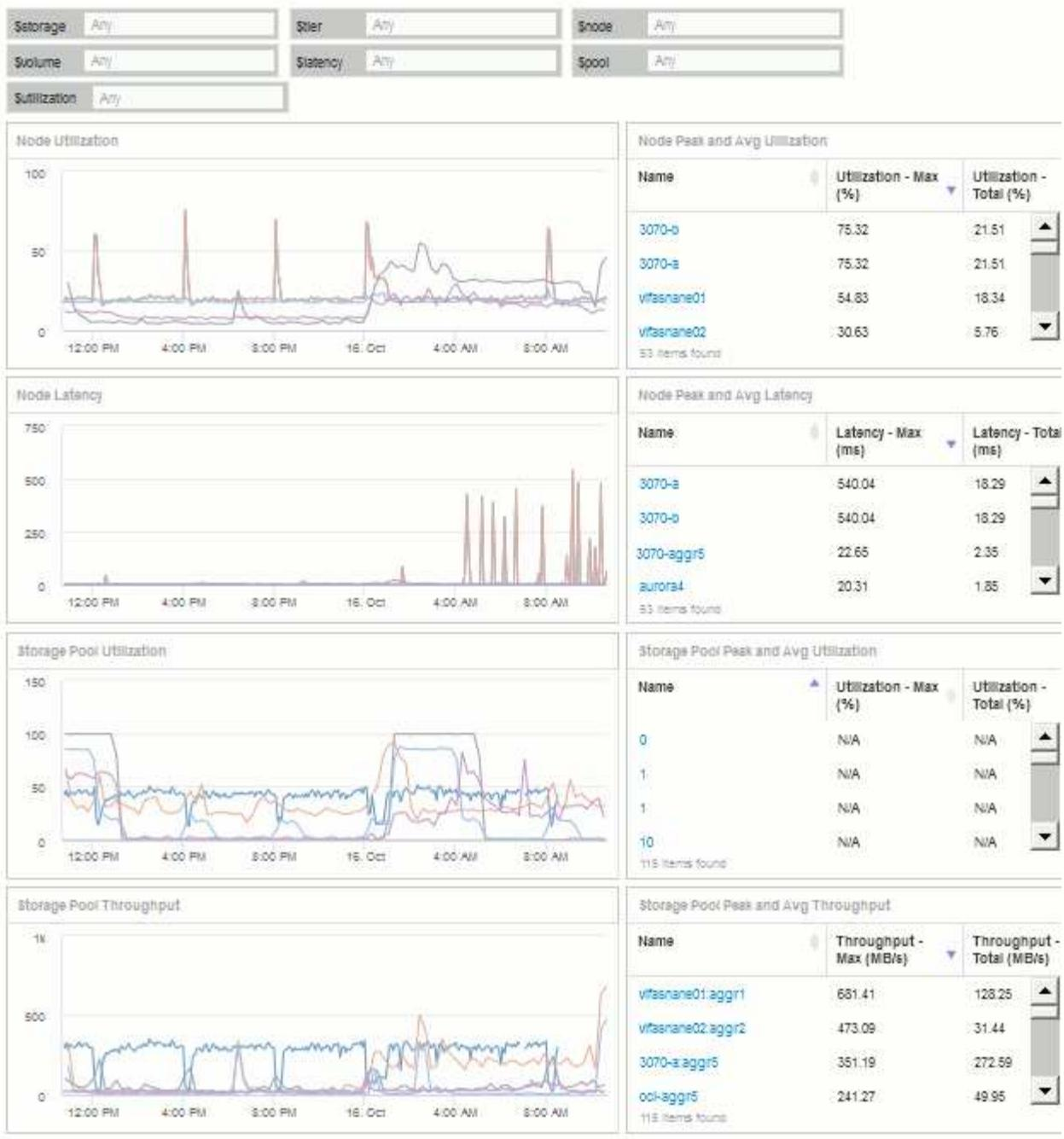
2. Puede utilizar las variables para centrarse en activos específicos del panel. A medida que introduce valores en los campos de variables, los widgets se actualizan automáticamente para reflejar esas variables. Por ejemplo, al introducir «'15'» en el campo \$Utilization variable, los widgets que utilizan dicha actualización de variable para mostrar sólo los activos con utilización total  $\geq 15\%$ .
