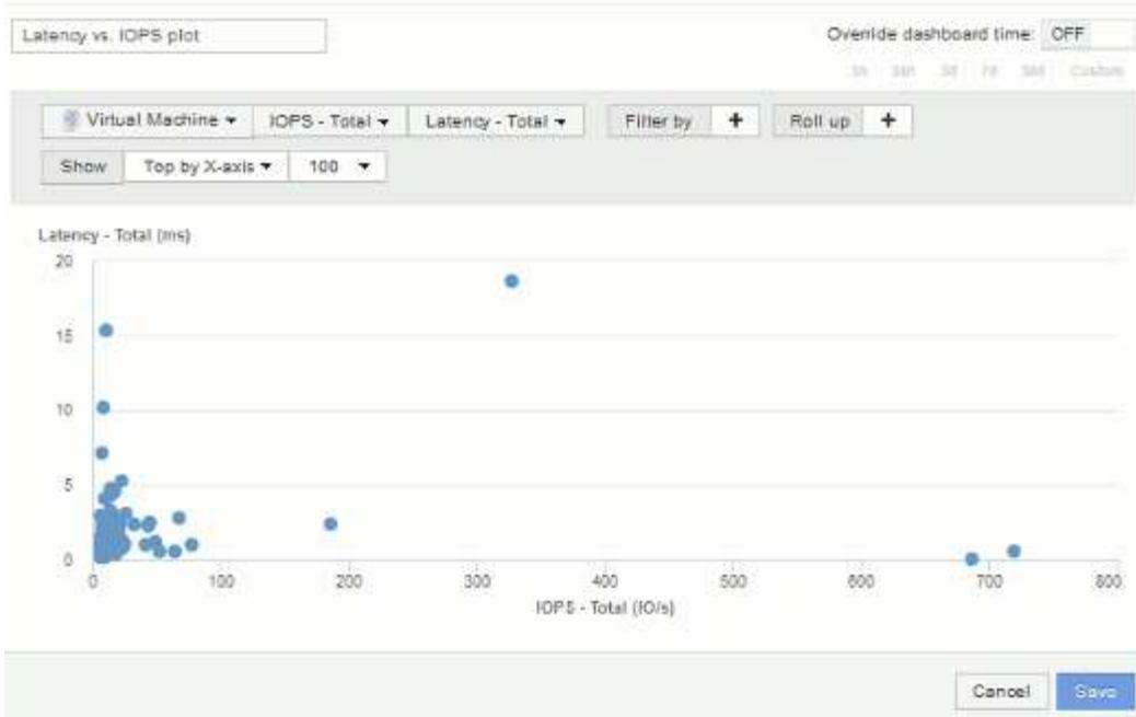
6. Puede elegir que el gráfico muestre la parte superior N por eje X, la parte superior N por eje y, la parte inferior N por eje X o la parte inferior N por eje Y. En nuestro último ejemplo, el gráfico muestra los 100 VM principales que tienen el *total* más alto de IOPS. Si lo cambiamos a Top por eje y, el gráfico volverá a mostrar los 100 VM principales que tienen el *total de latencia* más alto.
