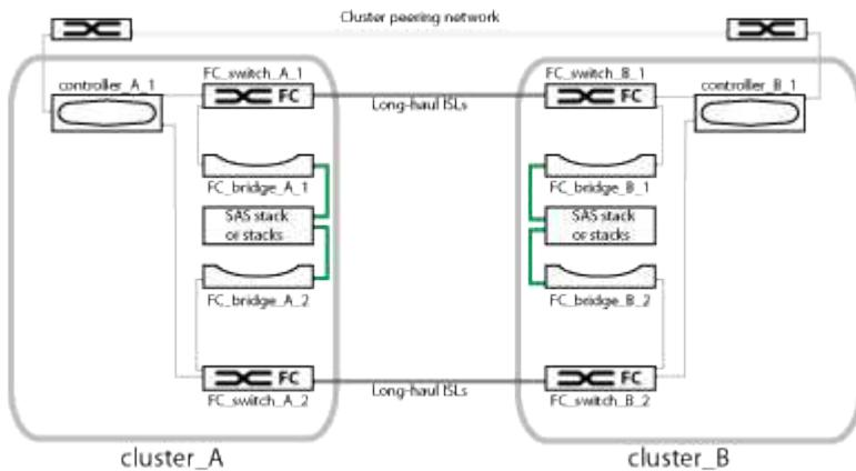
Una configuración de dos nodos consta de dos clústeres, uno en cada sitio separado geográficamente. Cluster\_A está situado en el primer sitio MetroCluster. Cluster\_B está situado en el segundo sitio MetroCluster. Cada sitio tiene una pila de almacenamiento SAS. Se admiten pilas de almacenamiento adicionales, pero solo se muestra una en cada sitio.
