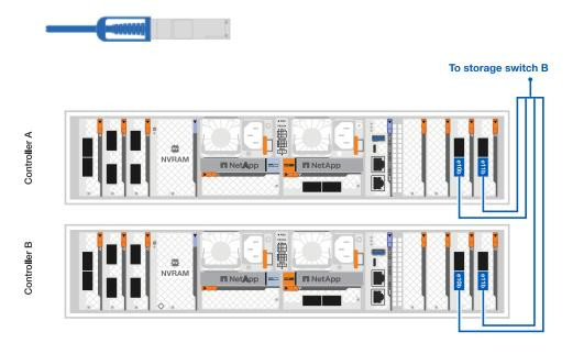
Paso 5: Conecte las conexiones del estante al conmutador
