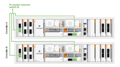
Paso 4: Conecte las conexiones de almacenamiento del controlador al conmutador
