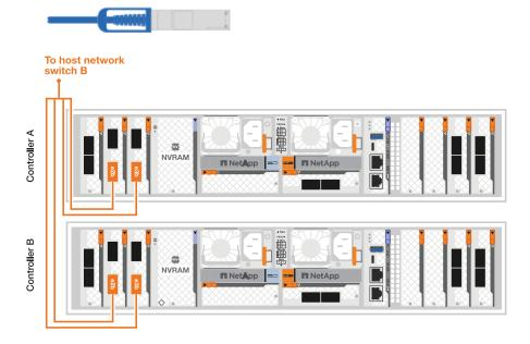
Paso 3: Conecte el clúster y las conexiones HA
