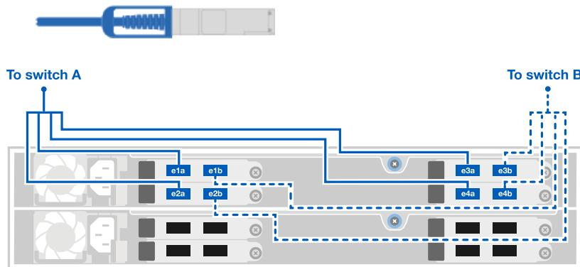
2. Conecte los siguientes puertos de estante a cualquier puerto que no sea ISL en el comutador A y el comutador B para el módulo B.
