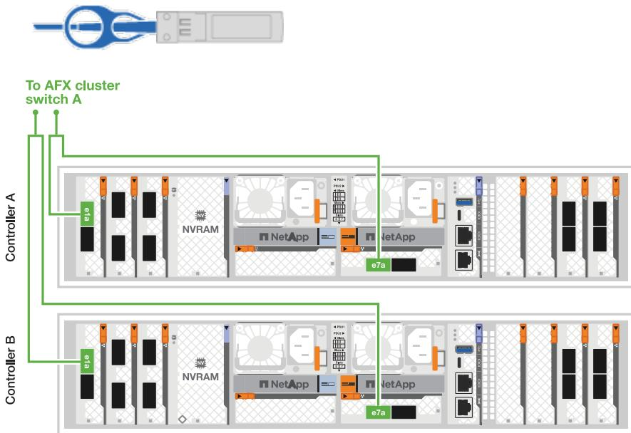
2. Conecte los siguientes puertos de controlador a cualquier puerto que no sea ISL en el conmutador de red del clúster B.
