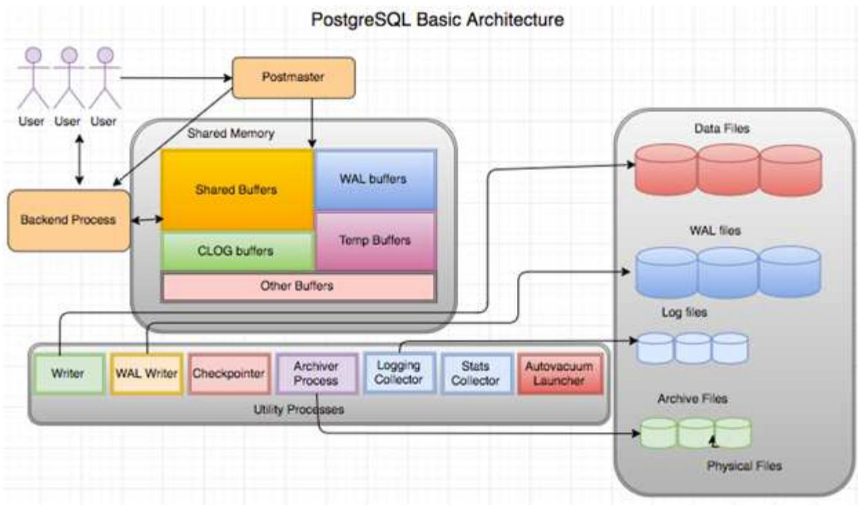
Hay tres elementos principales en una base de datos PostgreSQL: El postmaster, el front-end (cliente) y el back-end. El cliente envía solicitudes al postmaster con información como el protocolo IP y a qué base de datos conectarse. El posmaster autentica la conexión y la pasa al proceso back-end para continuar la comunicación. El proceso back-end ejecuta la consulta y envía los resultados directamente al front-end (cliente).
