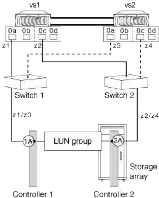
Los puertos de iniciador 0A de las controladoras VS1 y VS2 están conectados al puerto 1A de la cabina de almacenamiento y los puertos 0C de las controladoras están conectados al puerto 2A de la cabina de almacenamiento.
