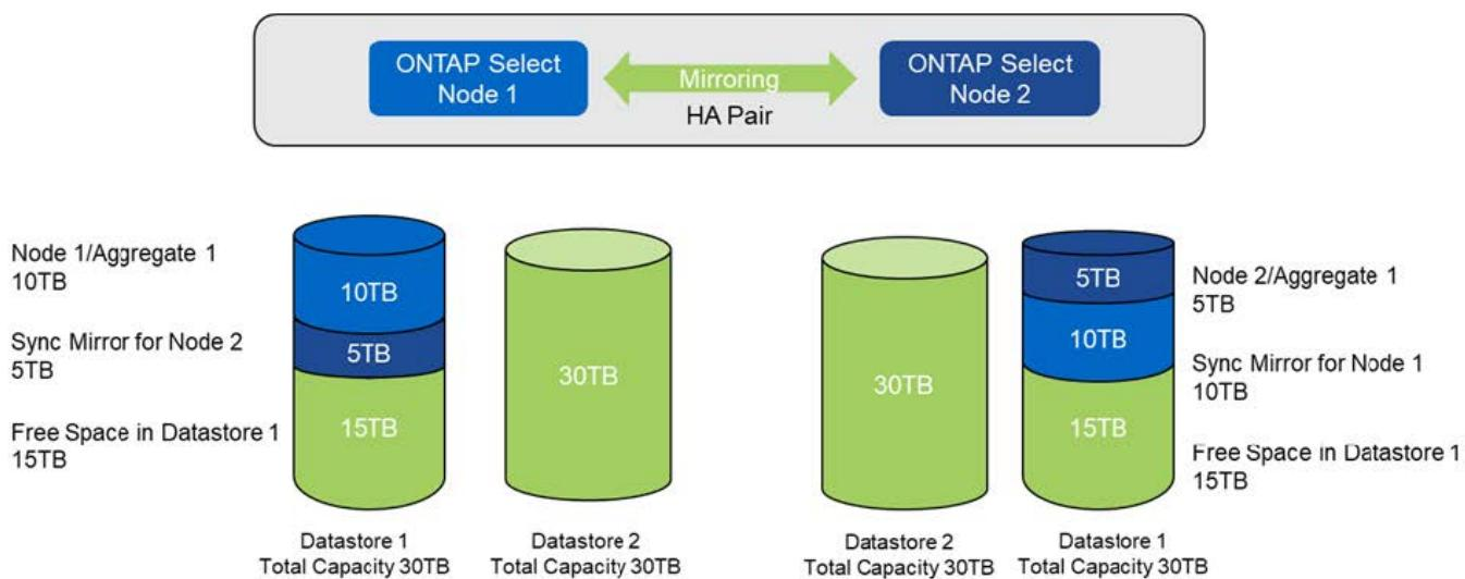
Dos operaciones adicionales de almacenamiento añadido en el nodo 1 consumen el resto del almacén de datos 1 y una parte del almacén de datos 2 (con capacidad límite). La primera operación de almacenamiento añadido consume los 15 TB de espacio libre que queda en el almacén de datos 1. En la siguiente figura, se muestra el resultado de la segunda operación de almacenamiento-adición. En este punto, el nodo 1 tiene 50 TB de datos activos a gestionar, mientras que el nodo 2 tiene el 5 TB original.
