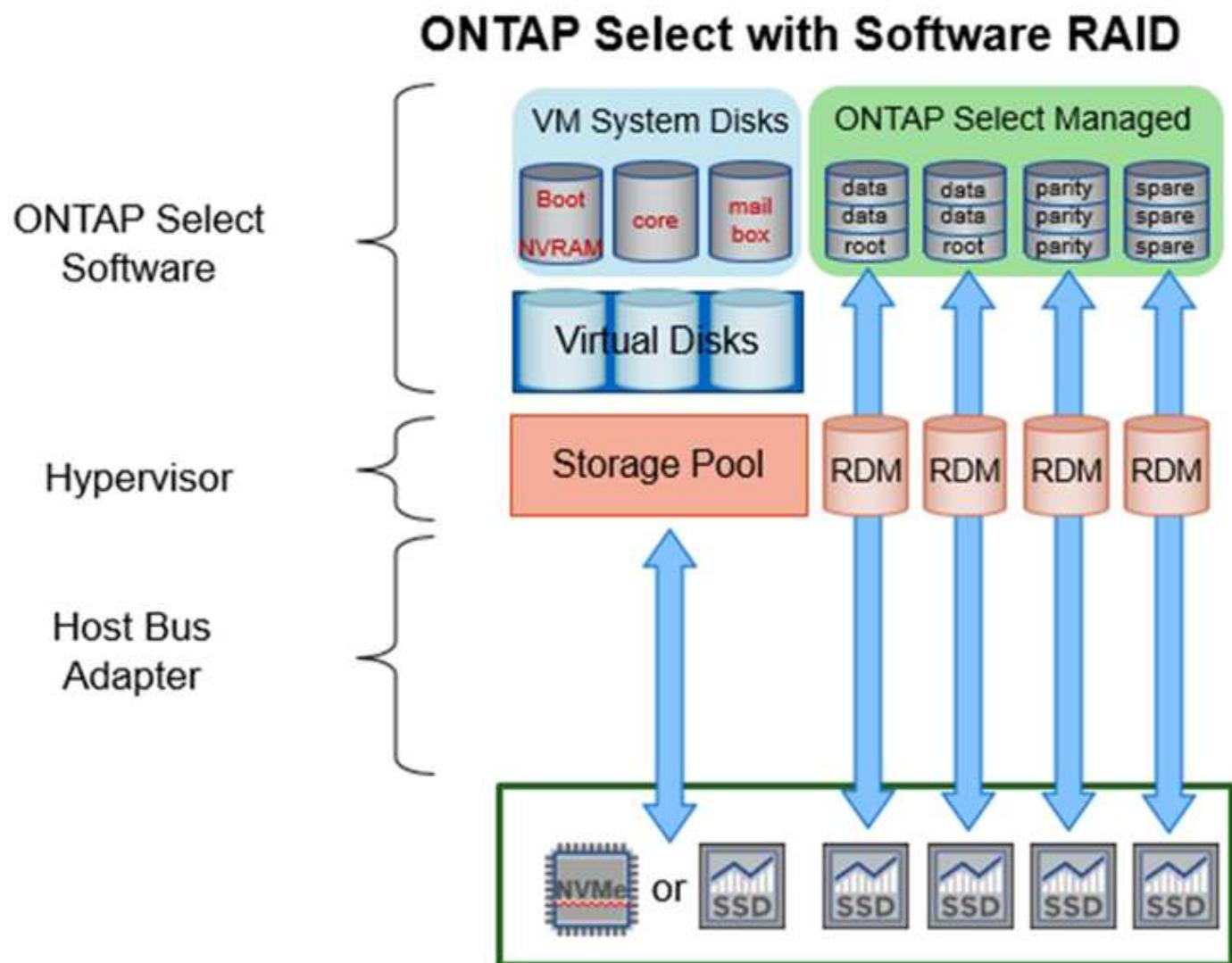
Los discos del sistema (VMDK) residen en el mismo almacenamiento de datos y en el mismo disco físico. El disco NVRAM virtual requiere un medio rápido y duradero. Por lo tanto, solo se admiten almacenamientos de datos de tipo NVMe y SSD.
