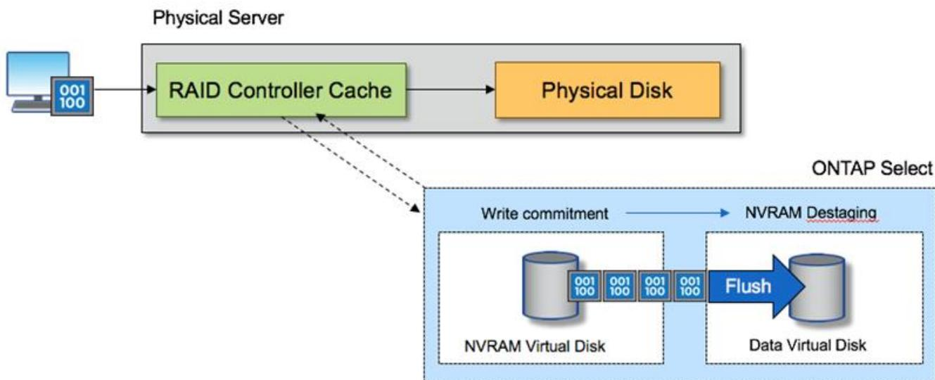
**i** La partición NVRAM está separada en su propio VMDK. Este VMDK se conecta mediante el controlador vNVME disponible en las versiones ESX 6.5 o posteriores. Este cambio es especialmente significativo para las instalaciones de ONTAP Select con RAID por software, que no se benefician de la caché del controlador RAID.
