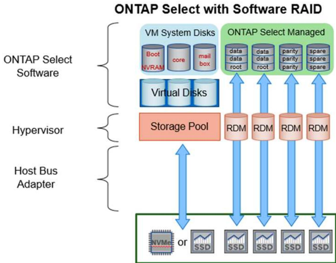
Los discos de sistema (VMDK) residen en el mismo almacén de datos y en el mismo disco físico. El disco NVRAM virtual requiere un medio rápido y duradero. Por lo tanto, solo se admiten almacenamientos de datos NVMe y de tipo SSD.
