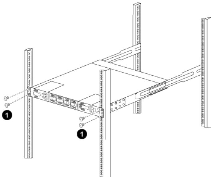
(1) *Mientras una persona sujeta la parte frontal del chasis nivelada, la otra persona debe apretar completamente los cuatro tornillos traseros a los postes del gabinete.*
