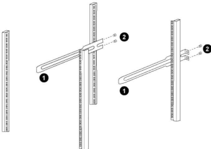
(1) Al deslizar suavemente el riel deslizante, alinéelo con los orificios para tornillos del soporte.
