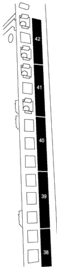
Los dos commutadores 9336C-FX2 siempre se montarán en la parte superior 2U del armario RU41 y 42.
