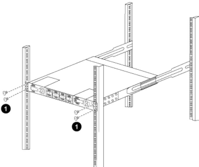
(1) con una persona sujetando la parte delantera del chasis, la otra persona debe apretar completamente
