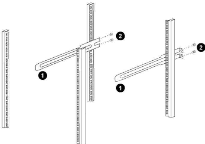
(1) mientras desliza suavemente el raíl deslizante, alinéelo con los orificios de los tornillos del rack.
