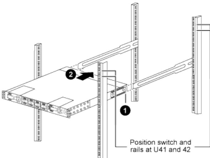
(1) A medida que el chasis se desplaza hacia los postes traseros, alinee las dos guías de montaje del rack trasero con los rieles deslizantes.
