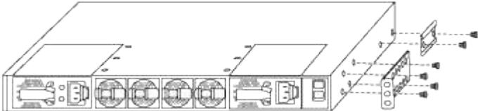
b. Repita el paso 2a con el otro soporte de montaje en rack frontal en el otro lado del conmutador.
