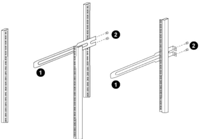
(1) Al deslizar suavemente el riel deslizante, alinéelo con los orificios para tornillos del estante. + (2) Apriete los tornillos de los rieles deslizantes a los postes del gabinete.
