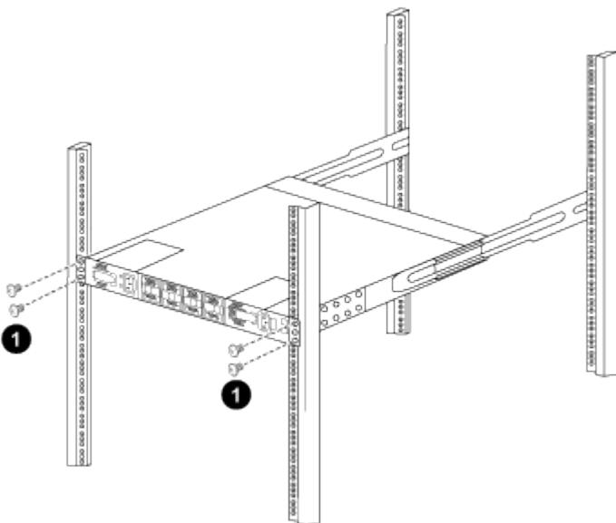
(1) Mientras una persona sujetla la parte frontal del chasis nivelada, la otra persona debe apretar completamente los cuatro tornillos traseros a los postes del gabinete.
