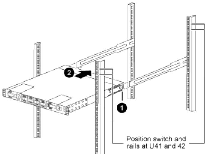
(1) a medida que el chasis se empuja hacia los postes traseros, alinee las dos guías de montaje en bastidor trasero con los rieles deslizantes.
