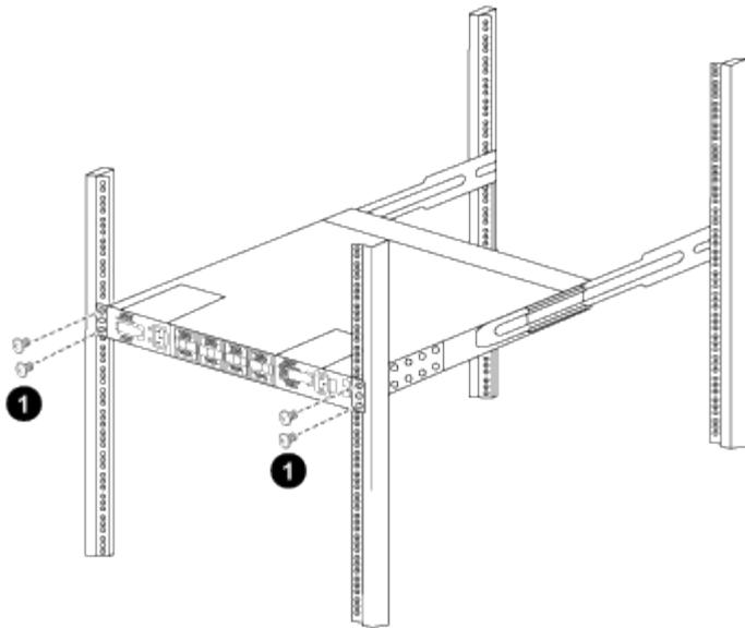
(1) con una persona sujetando la parte delantera del chasis, la otra persona debe apretar completamente los cuatro tornillos traseros a los postes del armario.
