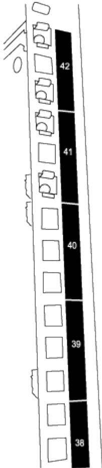
Los dos conmutadores 9336C-FX2 siempre se montarán en la parte superior 2U del armario RU41 y 42.
