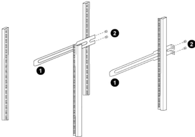
(1) mientras desliza suavemente el raíl deslizante, alinélo con los orificios de los tornillos del rack.
