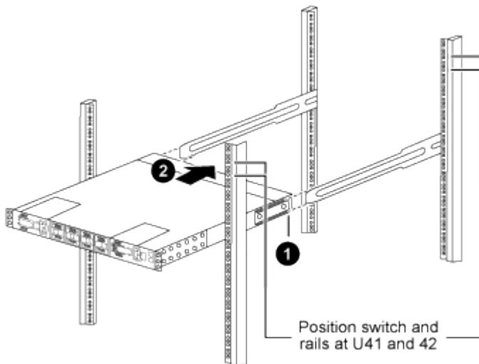
(1) a medida que el chasis se empuja hacia los postes traseros, alinee las dos guías de montaje en bastidor trasero con los rieles deslizantes.
