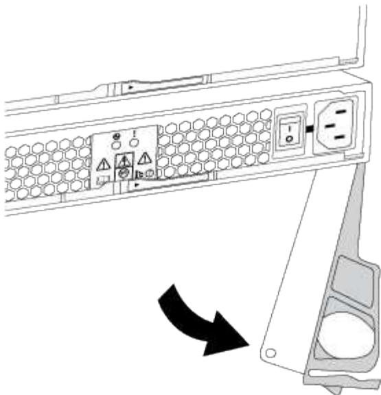
6. Utilice el asa de leva para extraer la fuente de alimentación de la bandeja de discos.
