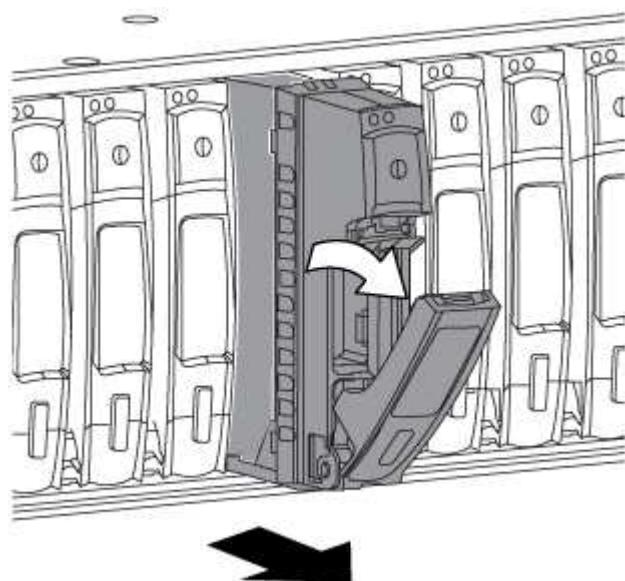
6. Deslice ligeramente hacia fuera la unidad de disco para permitir que el disco se reduzca de forma segura y, a continuación, extraiga la unidad de disco de la bandeja de discos.
