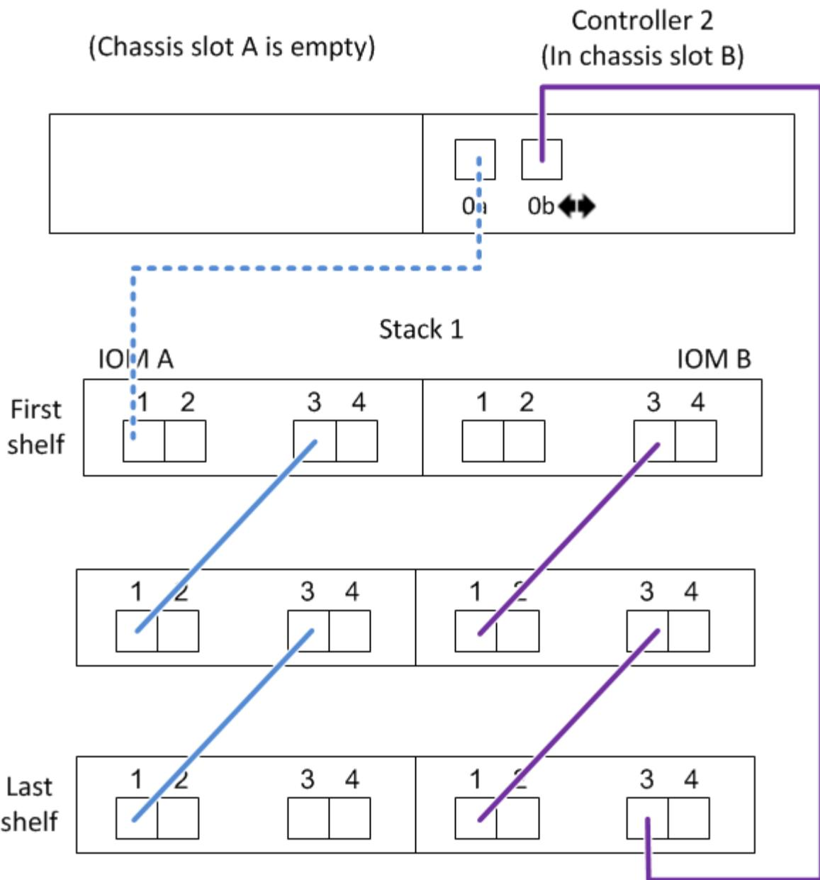
Hoja de trabajo de cableado para una configuración de alta disponibilidad de cuatro rutas con dos HBA SAS de cuatro puertos: DS212C, DS224C o DS460C
