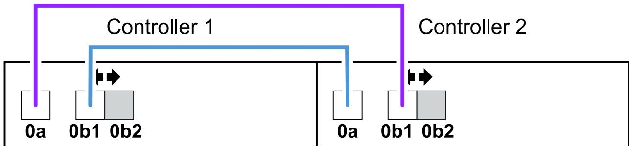
Plataforma FAS2820 en una configuración de alta disponibilidad de tres rutas con una pila de varias bandejas
