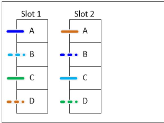
En el siguiente ejemplo de hoja de cálculo y cableado se muestran los pares de puertos que se omiten para utilizarlos entre sí en la lista: 1a/2b y 1c/2d.
