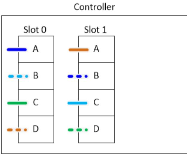
En el siguiente ejemplo de hoja de datos y cableado se muestran las parejas de puertos que se están omitiendo para utilizarlo entre sí de la lista: 0a/1b y 0c/1d.
