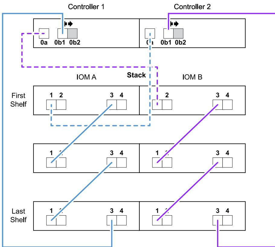
Plataformas con almacenamiento interno en una configuración de alta disponibilidad multivía con una pila de varias bandejas
