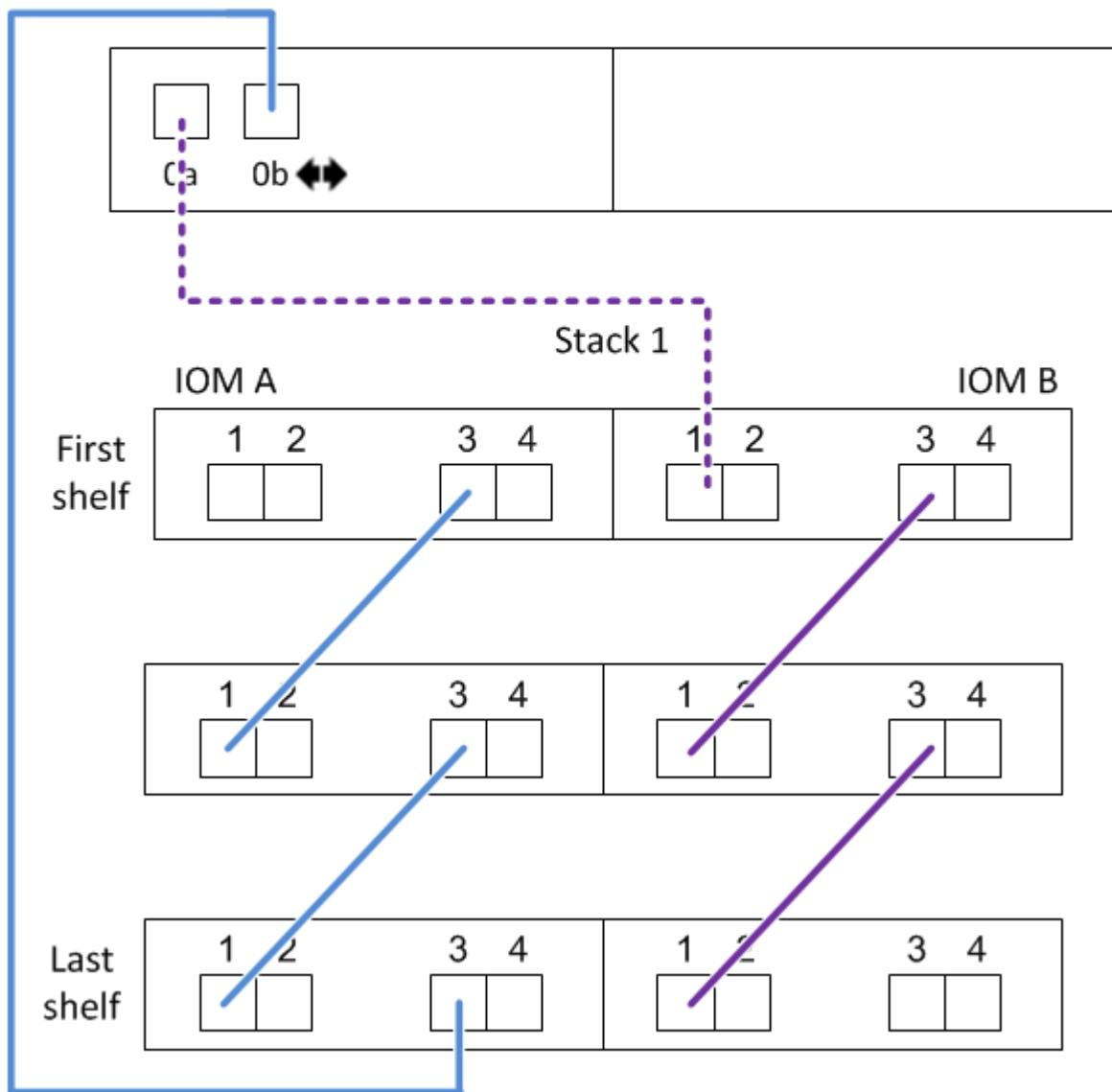
En este ejemplo, la controladora se instala en la ranura B del chasis. Cuando una controladora se encuentra en la ranura B del chasis, su puerto de almacenamiento interno (0b) se encuentra en el dominio B (IOM B); por lo tanto, el puerto 0b debe conectarse al dominio B (IOM B) en la pila.
