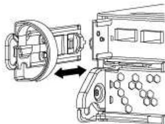
3. Apriete el pestillo del mango de la leva hasta que se suelte, abra el mango de la leva completamente para liberar el módulo del controlador del plano medio y, a continuación, tire con dos manos del módulo del controlador para extraerlo del chasis.
