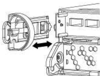
4. Apriete el pestillo del mango de la leva hasta que se suelte, abra el mango de la leva completamente para liberar el módulo del controlador del plano medio y, a continuación, tire con dos manos del módulo del controlador para extraerlo del chasis.
