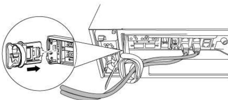
3. Afloje el tornillo de ajuste manual del asa de leva del módulo del controlador.
