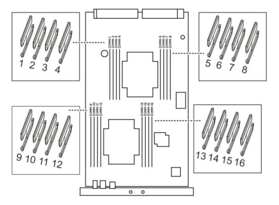
1. Extraiga el DIMM de su ranura empujando lentamente las dos lengüetas expulsoras del DIMM a ambos lados del DIMM y, a continuación, extraiga el DIMM de la ranura.
