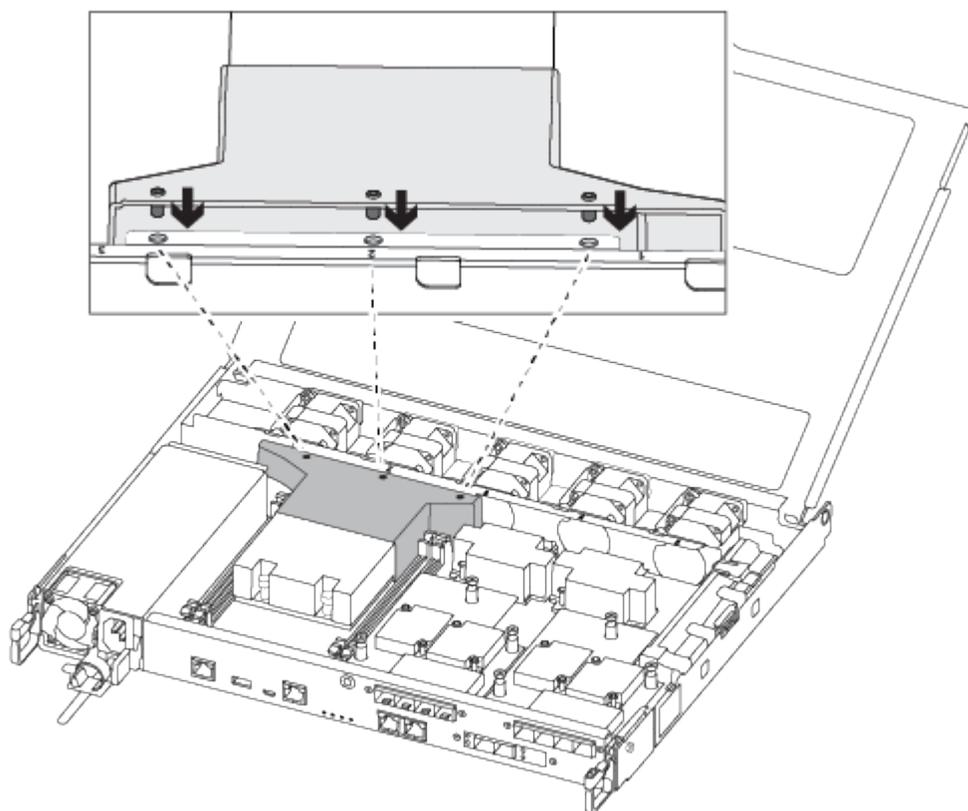
2. Cierre la cubierta del módulo del controlador y apriete el tornillo de mariposa.
