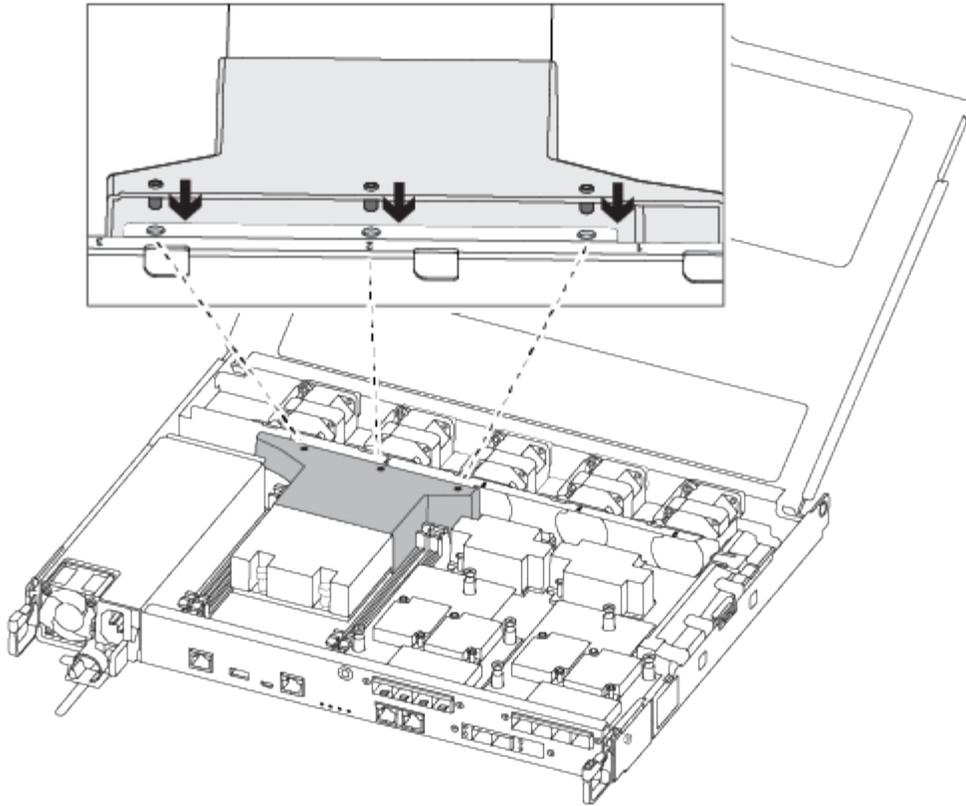
g. Cierre la cubierta del módulo del controlador y apriete el tornillo de mariposa.
