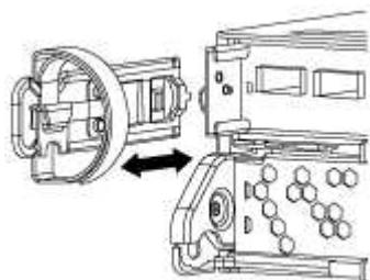
4. Apriete el pestillo del mango de la leva hasta que se suelte, abra el mango de la leva completamente para liberar el módulo del controlador del plano medio y, a continuación, tire con dos manos del módulo del controlador para extraerlo del chasis.
