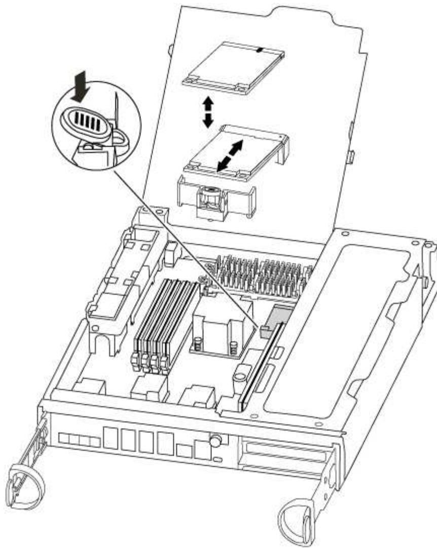
3. Pulse el botón azul de la carcasa del soporte de arranque para liberar el soporte de arranque de su carcasa y, a continuación, tire suavemente de él hacia fuera del zócalo del soporte de arranque.
