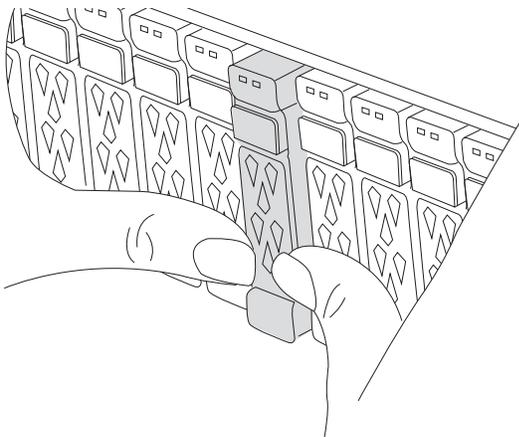
2. Asegúrese de que la separación de NVRAM se haya completado antes de continuar. Cuando el LED del módulo NV está apagado, NVRAM se separa. Si el LED parpadea, espere a que se detenga el parpadeo. Si el parpadeo continúa durante más de 5 minutos, póngase en contacto con el servicio de asistencia técnica para obtener ayuda.
