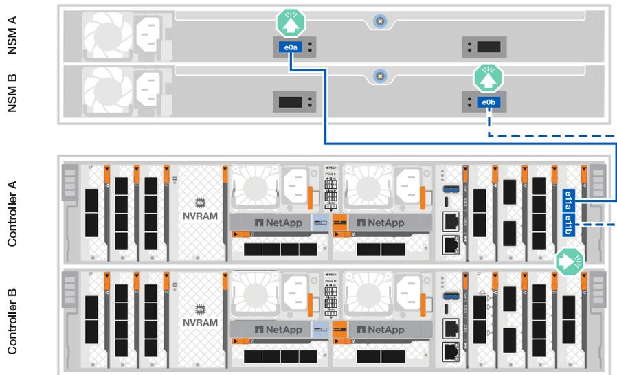
3. Conecte el puerto e11a de la controladora B al puerto NSM B e0a.
