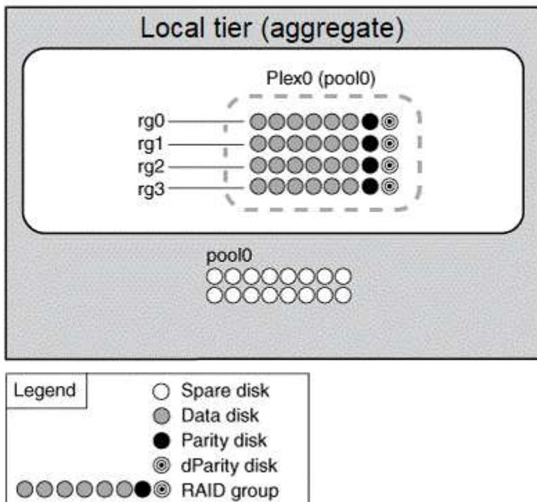
El siguiente diagrama muestra un nivel local no reflejado con LUN de cabina, agrupados en un plex. Tiene dos grupos RAID, rg0 y rg1. Todos los LUN de cabina utilizados por el nivel local proceden del mismo pool "pool0".
