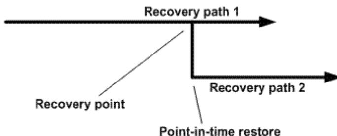
En la imagen, la ruta de recuperación 1 consta de un backup completo seguido por varios backups de registros de transacciones. Se restaura la base de datos a un momento específico. Se crean nuevos backups de registros de transacciones después de la operación de restauración a un momento específico, lo cual da
