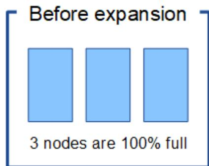
Para expandir el sitio en este ejemplo, se recomienda añadir tres o más nodos de almacenamiento nuevos. StorageGRID requiere tres nodos de almacenamiento para la codificación de borrado al 2+1 con el fin de poder colocar los dos fragmentos de datos y el fragmento de paridad en diferentes nodos.
