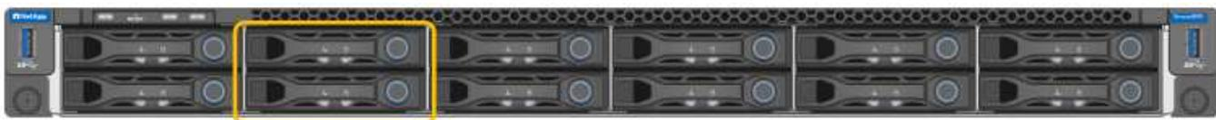
Las dos unidades de estado sólido (SSD), indicadas con el esquema naranja, se utilizan para almacenar el sistema operativo StorageGRID y se duplican con RAID 1 para la redundancia. Cuando el dispositivo de servicios SG100 o SG1000 se configura como un nodo de administración, estas unidades se utilizan para almacenar registros de auditoría, métricas y tablas de bases de datos.
