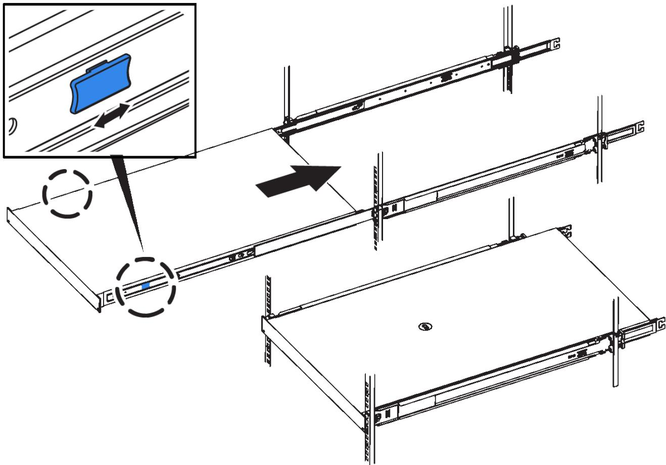
5. Apriete los tornillos cautivos del panel frontal del aparato para fijar el aparato en el rack.
