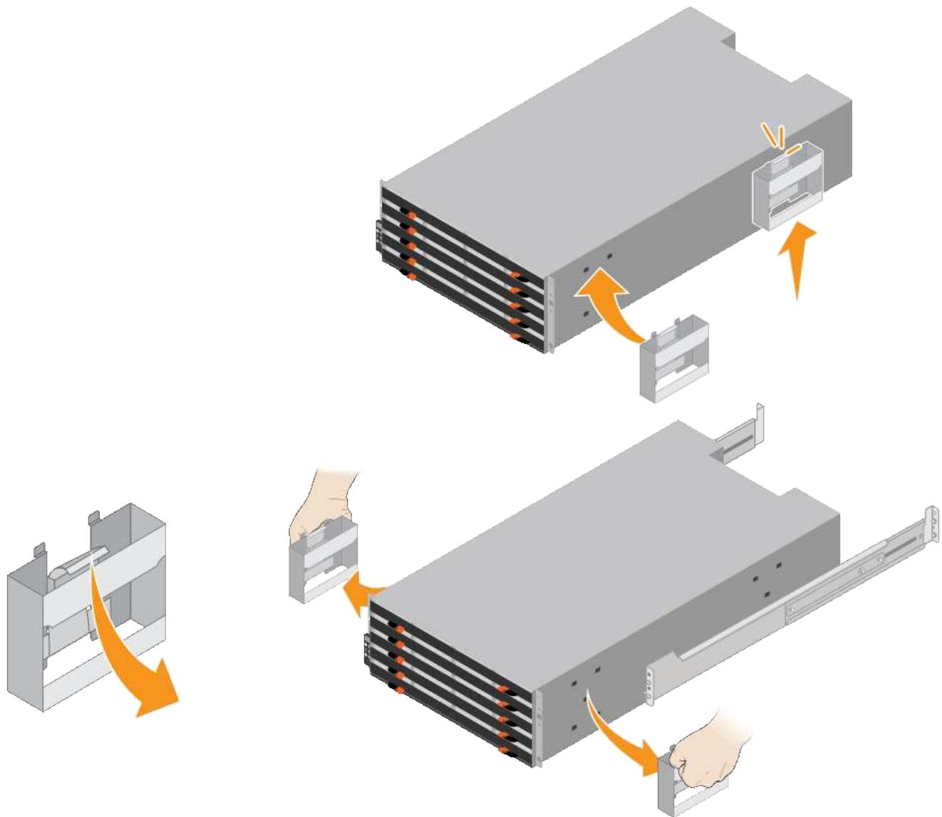
4. Coloque la parte posterior de la bandeja (el extremo con los conectores) en los rieles.
