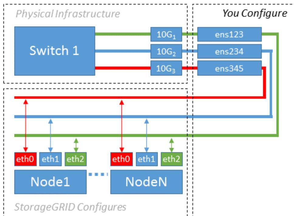
El sistema operativo Linux crea las interfaces ensXYZ automáticamente durante la instalación o el arranque, o cuando las interfaces se añaden en caliente. No se necesita ninguna configuración que no sea asegurarse de que las interfaces estén configuradas para que se encuentren en funcionamiento automáticamente después
