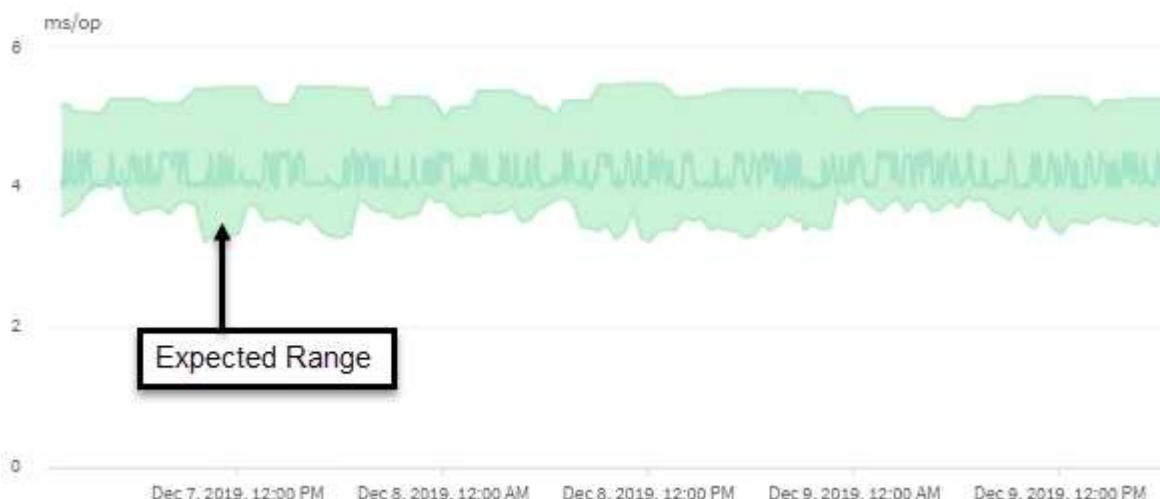
Dans cet exemple, la latence d'un volume a une prévision de latence, en gris, de 3,5 millisecondes par opération (ms/op) à son niveau le plus bas et de 5,5 ms/op à son niveau le plus élevé. Si la latence réelle, en bleu, augmente soudainement à 10 ms/op, en raison d'un pic intermittent de trafic réseau ou d'une contention sur un composant du cluster, elle est alors supérieure à la prévision de latence et a dépassé le seuil de performance dynamique.
