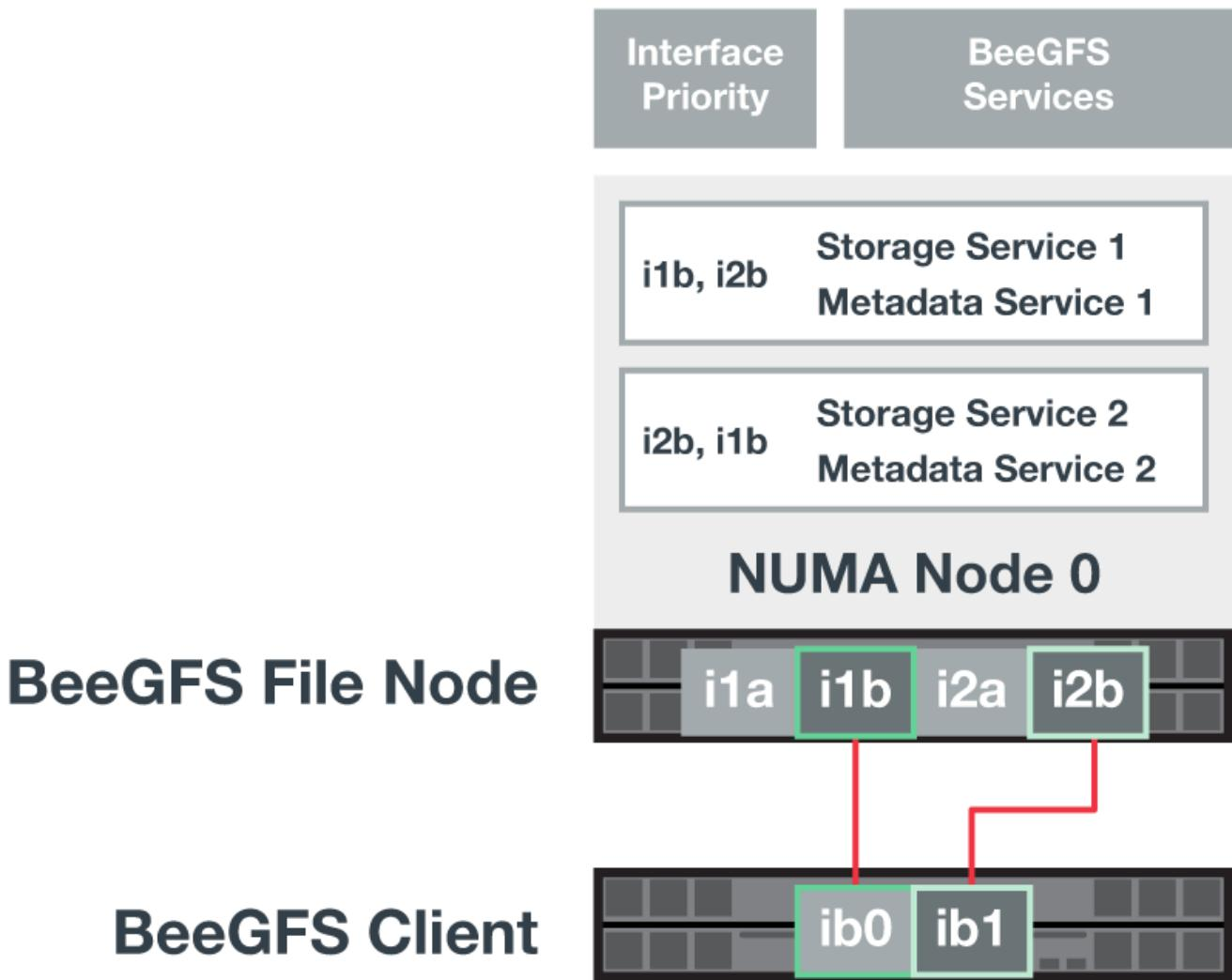
Comme chaque fichier de BeeGFS est généralement réparti sur plusieurs services de stockage, la configuration multi-rail permet au client d'atteindre un débit supérieur à celui d'un seul port InfiniBand. Par exemple, l'exemple de code suivant montre une configuration commune de répartition des fichiers qui permet au client d'équilibrer le trafic entre les deux interfaces :
