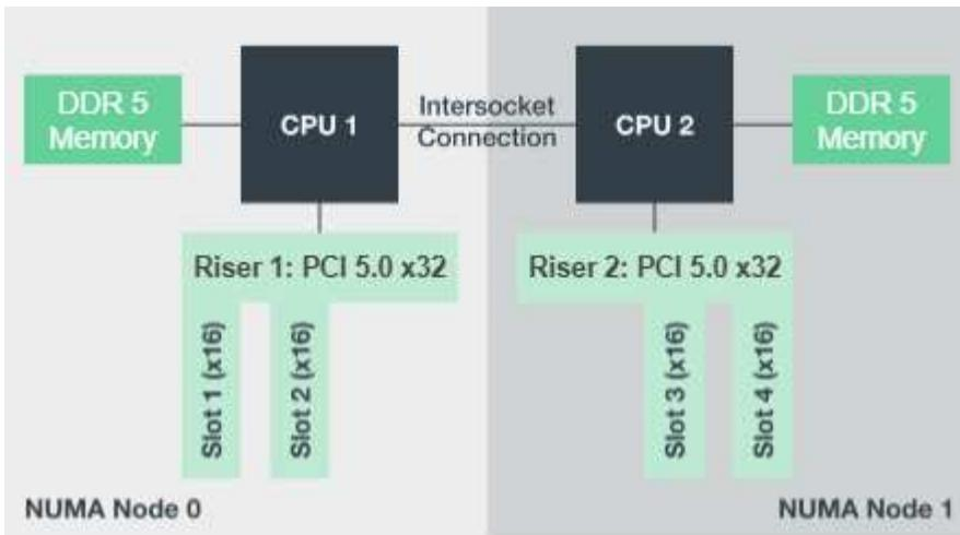
Les processus BeeGFS sont épinglés à une zone NUMA particulière pour s'assurer que les interfaces utilisées se trouvent dans la même zone. Cette configuration évite d'avoir besoin d'un accès à distance via la connexion inter-socket. La connexion inter-sockets est parfois appelée liaison QPI ou GMI2 ; même dans les architectures de processeurs modernes, ils peuvent être un goulot d'étranglement lors de l'utilisation de réseaux haut débit comme HDR InfiniBand.
