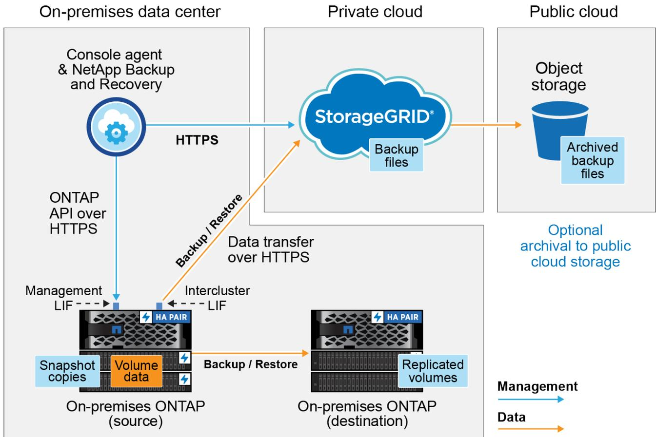
Lorsque l'agent de console et le système ONTAP sur site sont installés dans un emplacement sur site sans accès Internet (un « site sombre »), le système StorageGRID doit être situé dans le même centre de données sur site. L'archivage des anciens fichiers de sauvegarde dans le cloud public n'est pas pris en charge dans les configurations de site sombre.
