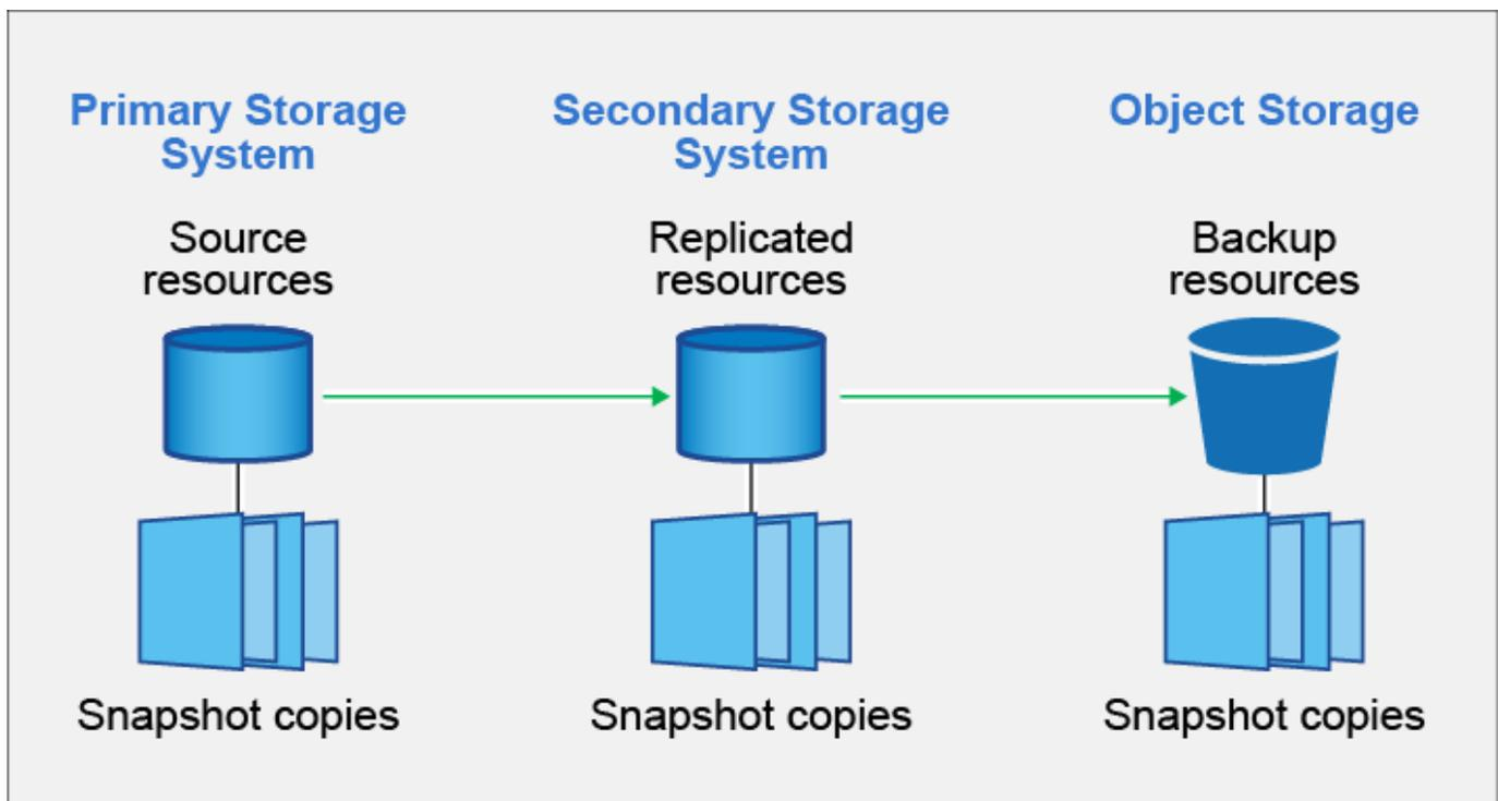
NetApp Backup and Recovery exploite la technologie de réplication de données SnapMirror de NetApp pour garantir que toutes les sauvegardes sont entièrement synchronisées en créant des copies Snapshot et en les transférant vers les emplacements de sauvegarde.
