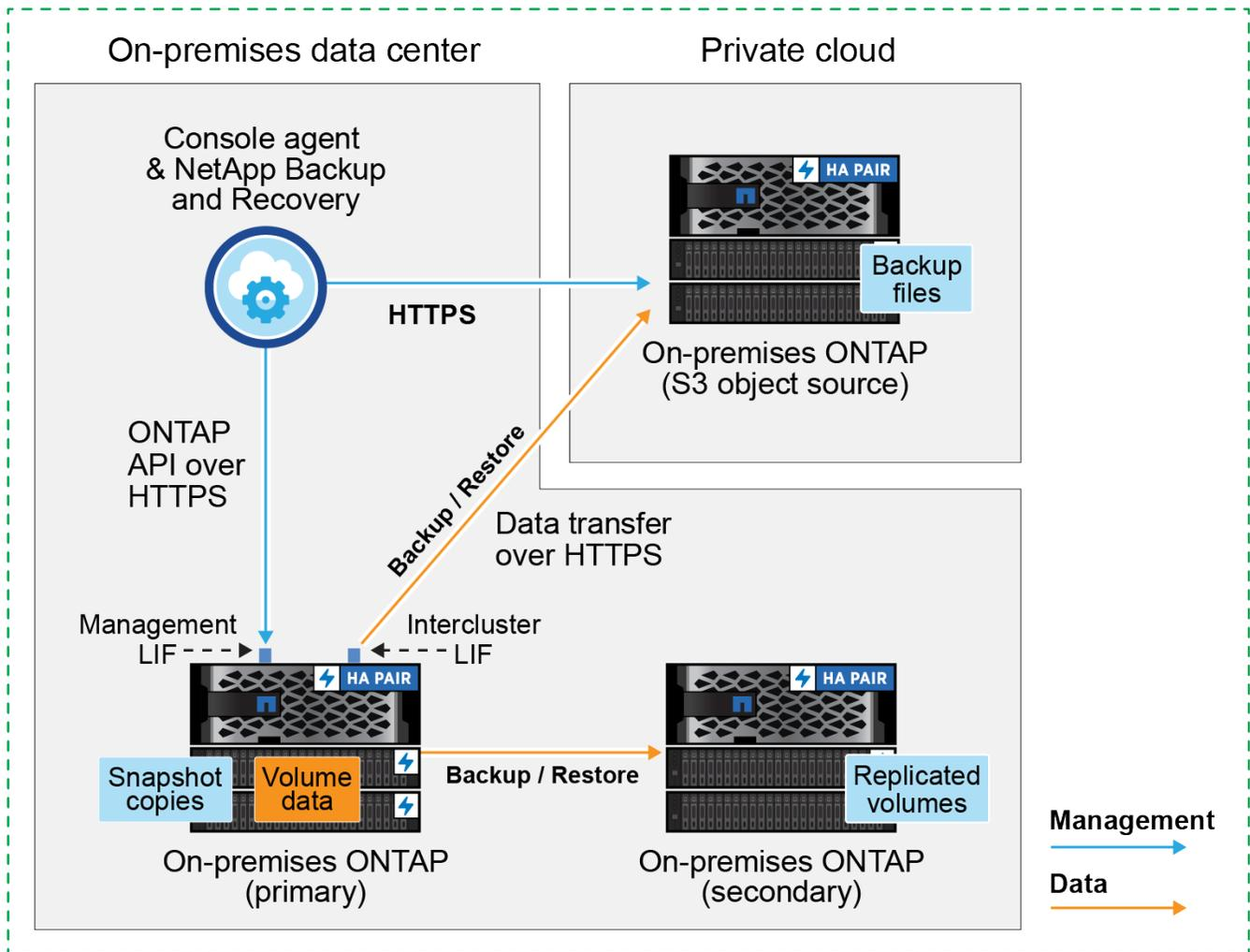
Lorsque l'agent de console et le système ONTAP principal sur site sont installés dans un emplacement sur site sans accès Internet (déploiement en mode « privé »), le système ONTAP S3 doit être situé dans le même centre de données sur site.
