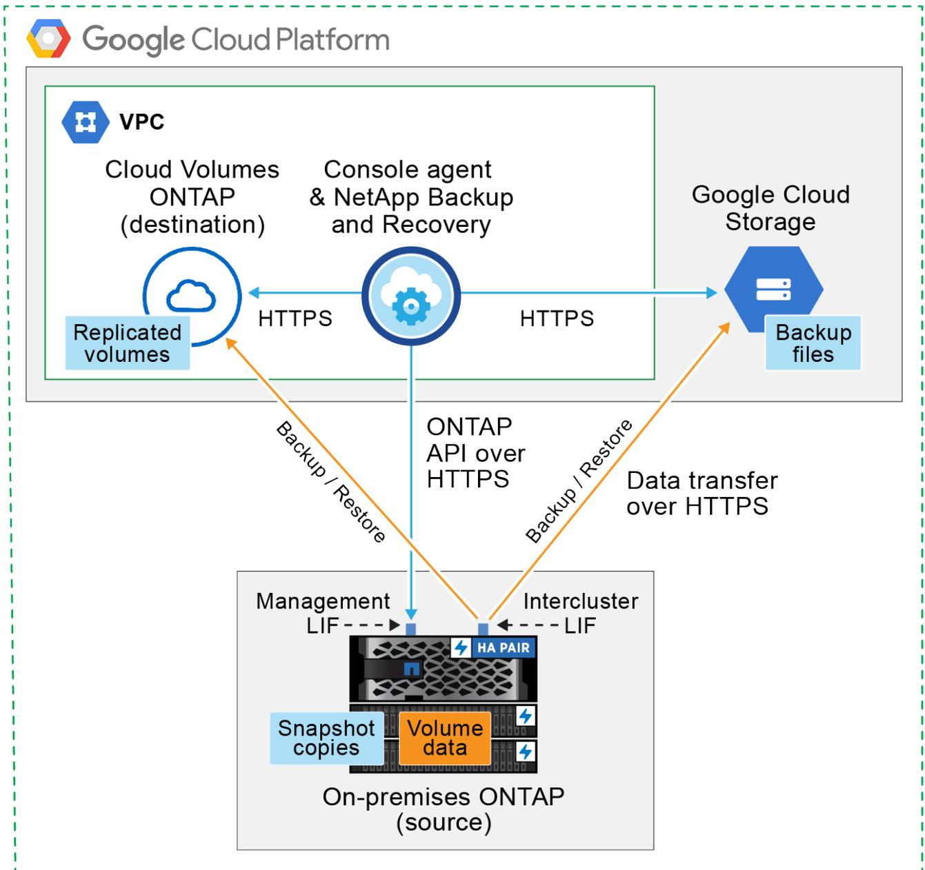
Le diagramme suivant montre la méthode de **connexion privée** et les connexions que vous devez préparer entre les composants. L'agent de console doit être déployé dans le VPC Google Cloud Platform.
