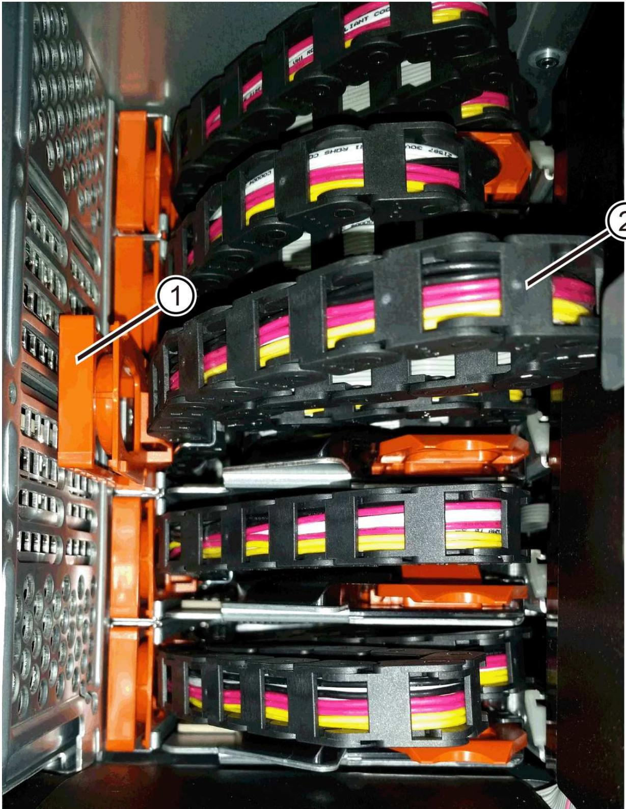
(1) bague orange sur rail de guidage vertical
