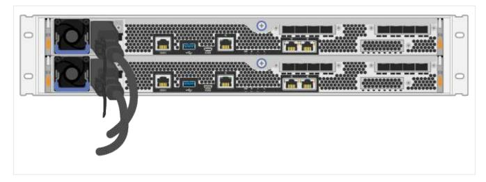
2. Connectez les deux câbles d'alimentation, un de chaque contrôleur, à deux unités de distribution d'alimentation séparées dans l'armoire ou le rack.
