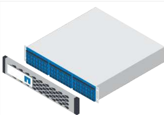
Tiroir avec disques installés (caches cadres et embouts fournis séparément)
