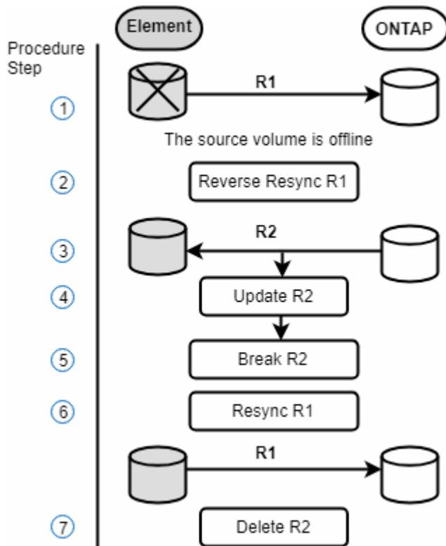
L'image suivante montre le scénario de retour arrière lorsque le volume source n'existe plus :
