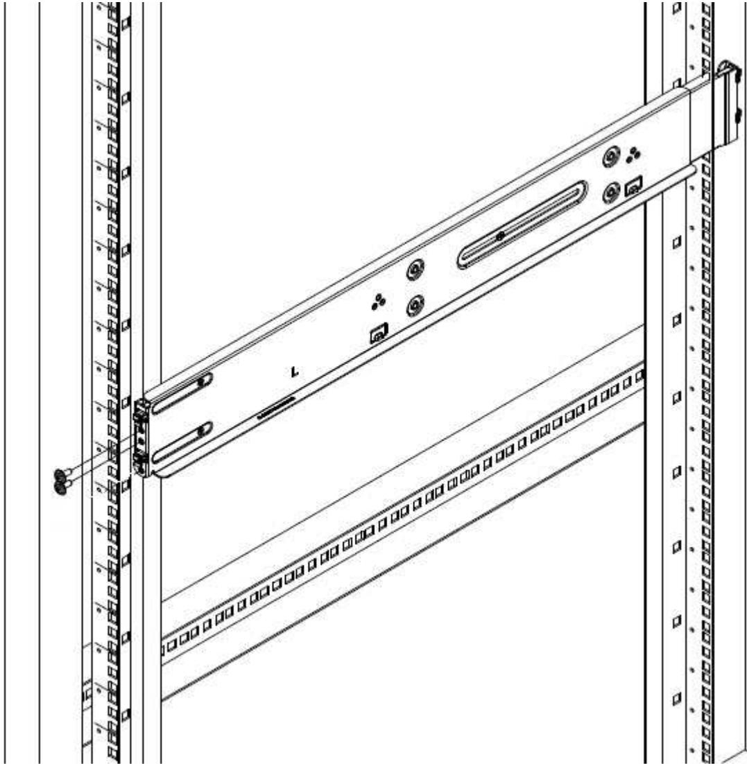
4. Étendre la section arrière du rail jusqu'au montant arrière du rack.
