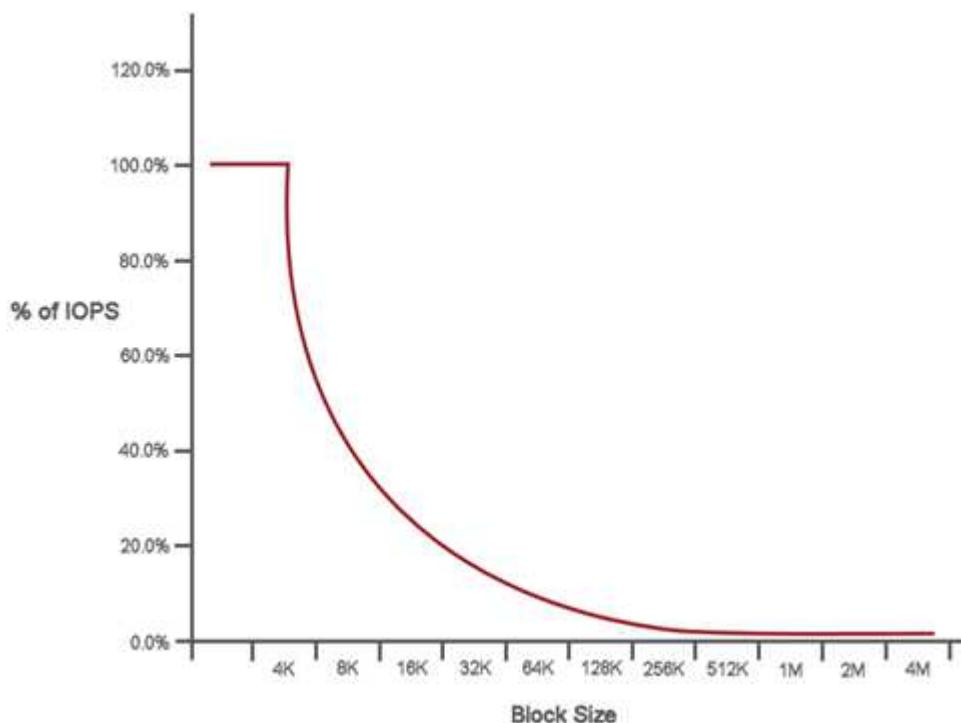
Par exemple, si les tailles de bloc sont de 4 ko et que la bande passante est de 4000 kbit/s, le nombre d'IOPS est de 1000. Si les tailles de bloc augmentent à 8 Ko, la bande passante augmente à 5000 kbit/s et les IOPS diminuent à 625. En prenant en compte la taille des blocs, le système s'assure que des charges de travail
