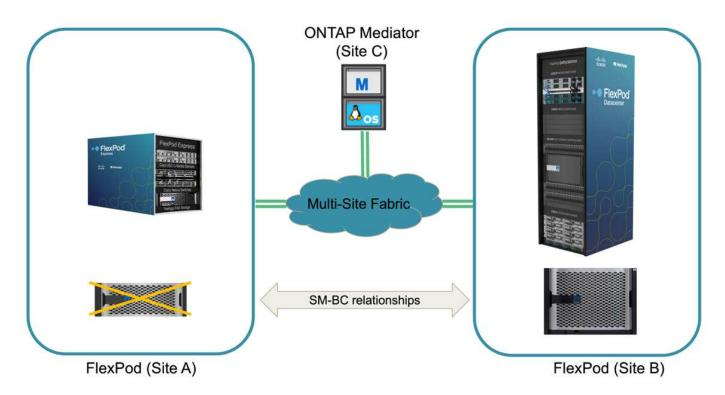
Pour simuler un incident de stockage au niveau du site A, les deux contrôleurs de stockage du site A peuvent être mis hors tension en mettant physiquement l'interrupteur afin de mettre fin à l'alimentation des contrôleurs, ou en utilisant la commande de gestion de l'alimentation système des processeurs de service du contrôleur de stockage pour mettre les contrôleurs hors tension.
