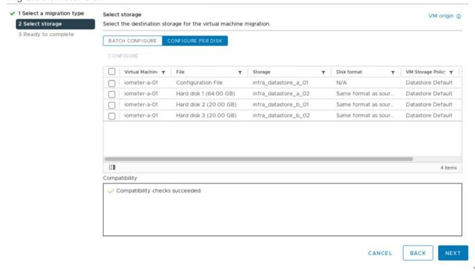
Des tests de vMotion d'machines virtuelles sur un hôte différent au niveau du même site, ainsi que sur plusieurs sites ont été réalisés et ont abouti. Après avoir migré manuellement une machine virtuelle sur plusieurs sites, la règle d'affinité VM/hôte s'active et retransfère la machine virtuelle au groupe où elle appartient dans la condition normale.
