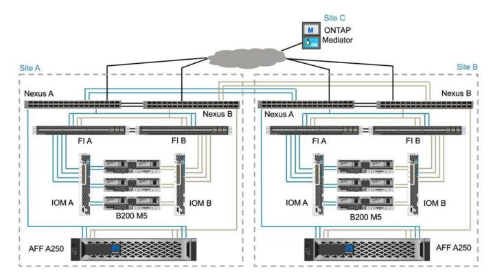
L'architecture de déploiement FlexPod est identique sur chaque site pour la validation de cette solution. Cependant, elle prend en charge les déploiements asymétriques et peut également être ajoutée aux solutions FlexPod existantes s'ils répondent aux exigences.
