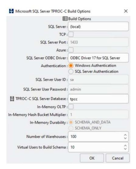
Une fois les options de création de schéma mises à jour, le processus de création de schéma a démarré. Quelques minutes plus tard, une erreur simulée de cluster de stockage du site B a été introduite en mettant hors tension les deux nœuds du cluster de stockage AFF A250 à environ la même heure à l'aide des commandes CLI du processeur système.
