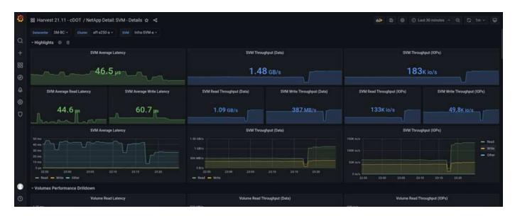
Le scénario de test d'incident de stockage ci-dessus a confirmé que la charge de travail de Microsoft SQL Server peut survivre à une panne complète du cluster de stockage sur le site B où réside la base de données. Une fois l'incident détecté et le basculement effectué, l'application a utilisé de manière transparente les services de données du site De cluster De stockage.
