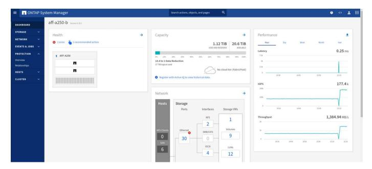
Le site D'Un cluster ne fonctionne pas, mais les relations des groupes cohérents s'affichent Out of sync état comme indiqué dans la figure suivante. Une fois que le système est de nouveau sous tension pour les contrôleurs de stockage du site A, le cluster de stockage démarre et la synchronisation des données entre le site A et le site B se produit automatiquement.
