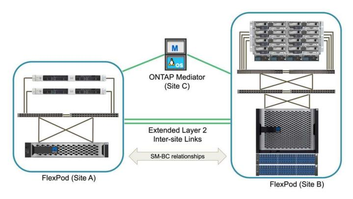
Pour les entreprises dont les besoins en ressources de calcul et de stockage sont plus importants et sur plusieurs sites, une structure multisite basée sur VXLAN permet à plusieurs sites d'avoir une structure réseau transparente afin de faciliter la mobilité des applications et de servir une application depuis n'importe quel site.
