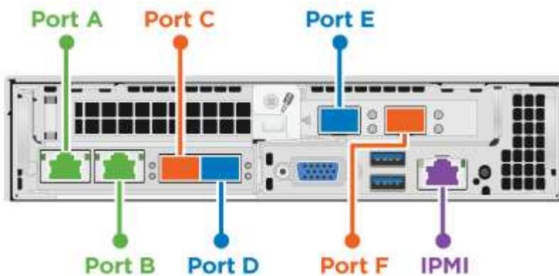
Voici les ports réseau et emplacements sur le nœud de stockage H410S :
