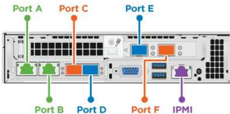
Voici les emplacements et ports réseau sur le nœud de calcul H610C :
