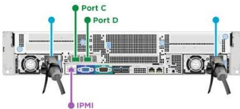
Voici les emplacements et ports réseau sur le nœud de calcul H615C :
