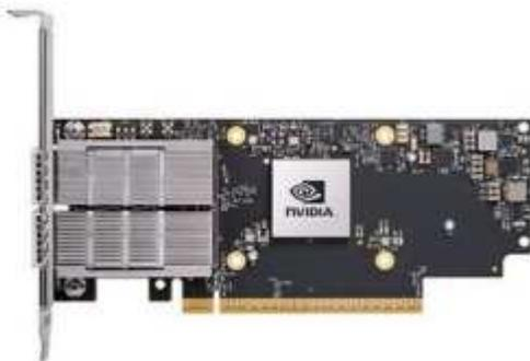
L'adaptateur NVIDIA ConnectX-7 peut fournir un débit de 25/50/100/200/400 G. Les systèmes NVIDIA DGX utilisent les adaptateurs ConnectX-7 à port unique et double pour offrir une flexibilité dans les déploiements DGX BasePOD avec InfiniBand 400 Gb/s et Ethernet.
