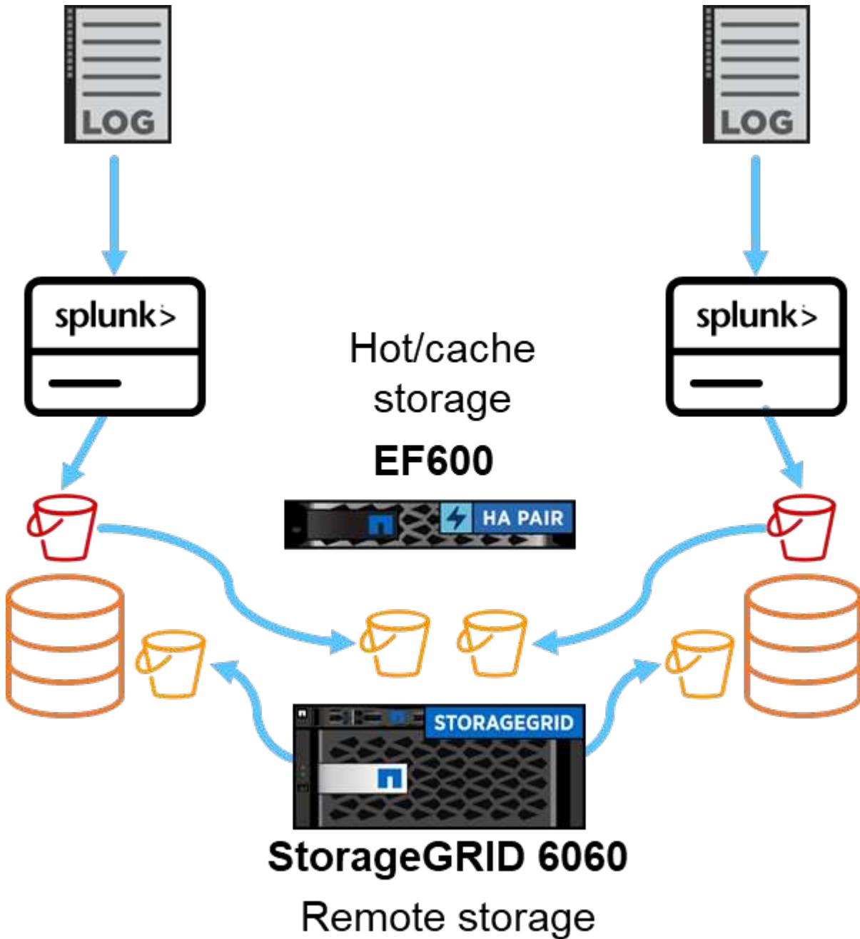
Nous avons utilisé EF600 pour le stockage à chaud/cache et StorageGRID 6060 pour le stockage à distance. Nous avons utilisé l'architecture suivante pour la validation des performances. Nous avons utilisé deux têtes de recherche, quatre transitaires lourds pour transmettre les données aux indexeurs, sept générateurs d'événements Splunk (Eventgens) pour générer les données en temps réel et 18 indexeurs pour stocker les données.
