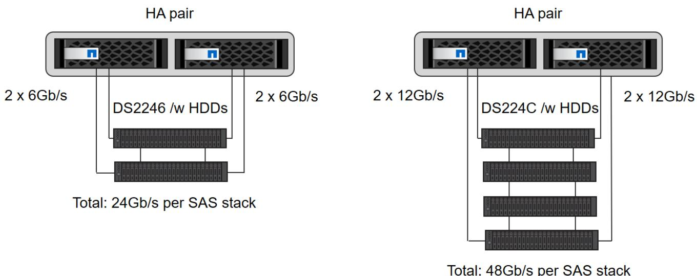
Avec les disques SSD, un maximum d'un tiroir disque peut être connecté à une pile SAS afin d'assurer les performances requises pour les hôtes SAP HANA, comme illustré dans la figure suivante. Les disques dans chaque tiroir doivent être répartis de manière homogène sur les deux contrôleurs de la paire haute disponibilité. Avec le tiroir disque DS224C, il est possible d'utiliser un câblage SAS à quatre chemins, sans qu'il soit nécessaire.
