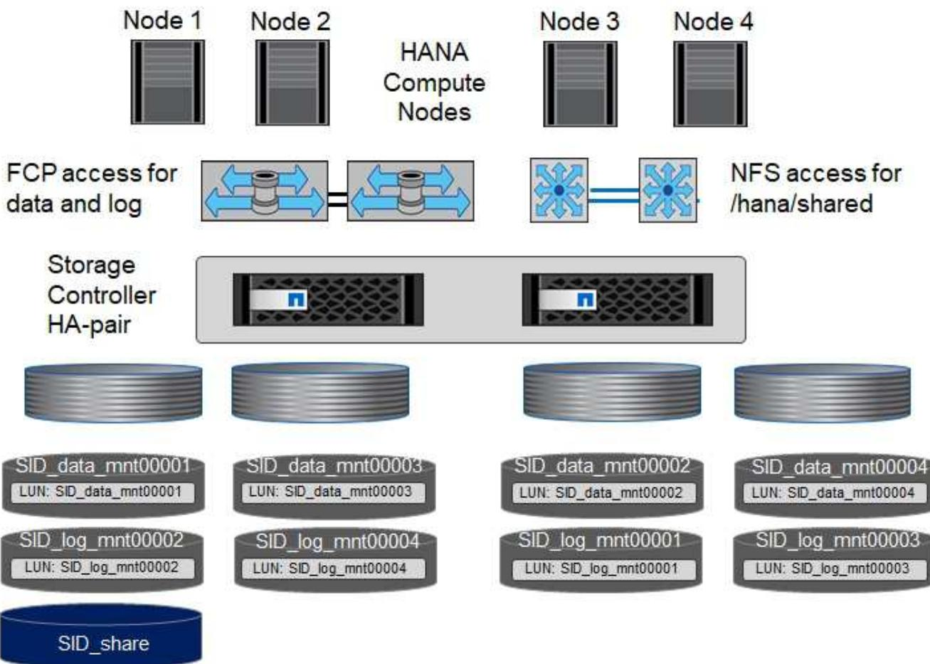
Pour chaque hôte SAP HANA, un volume de données et un volume journal sont créés. Le /hana/shared volume est utilisé par tous les hôtes du système SAP HANA. La figure suivante présente un exemple de configuration pour un système SAP HANA à plusieurs hôtes en 4+1.
