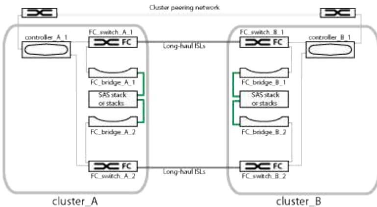
Une configuration à deux nœuds se compose de deux clusters, un sur chaque site géographiquement séparé. Cluster\_A est situé sur le premier site MetroCluster. Cluster\_B est situé sur le second site MetroCluster. Chaque site dispose d'une pile de stockage SAS. D'autres piles de stockage sont prises en charge, mais une seule s'affiche sur chaque site.
