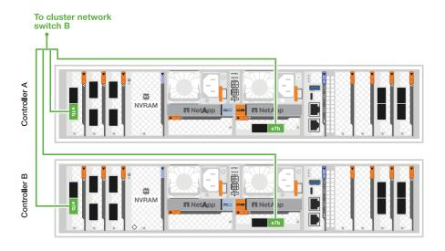
Étape 4 : Câblez les connexions de stockage du contrôleur au commutateur
