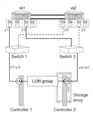
Les ports d'initiateur 0a des contrôleurs vs1 et vs2 sont connectés au port 1A de la matrice de stockage et les ports 0C des contrôleurs sont connectés au port 2A de la matrice de stockage.
