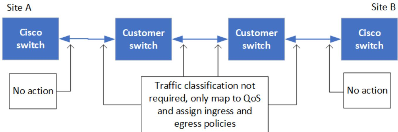
Le diagramme suivant présente les paramètres requis pour un réseau partagé lorsque les commutateurs externes sont des commutateurs IP Broadcom.
