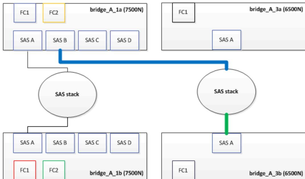
4. À l'aide d'un câble équipé d'un connecteur mini-SAS, connectez le même port SAS du shelf de stockage au port SAS B du pont Fibre Bridge 7600N ou 7500N inférieur.
