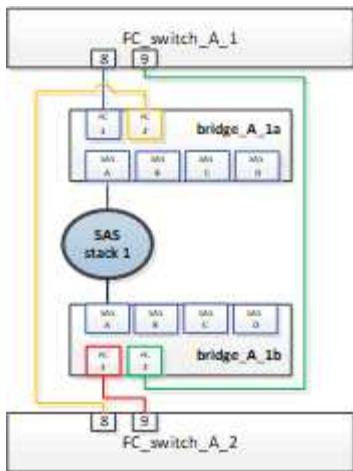
Les ports de commutateur 8 et 9 de chaque commutateur connectent les ponts au réseau.
