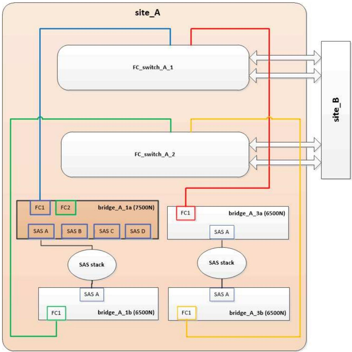
2. Vérifier la connectivité aux disques connectés par pont et que le nouveau FibreBridge 7500N est visible dans la configuration :
