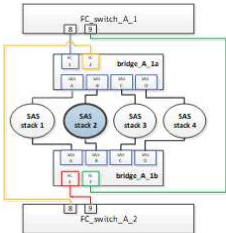
Le port SAS B connecte les ponts au shelf cible. En désactivant uniquement le port SAS B sur les deux tiroirs, les autres piles SAS continuent à transmettre des données pendant la procédure de remplacement.
