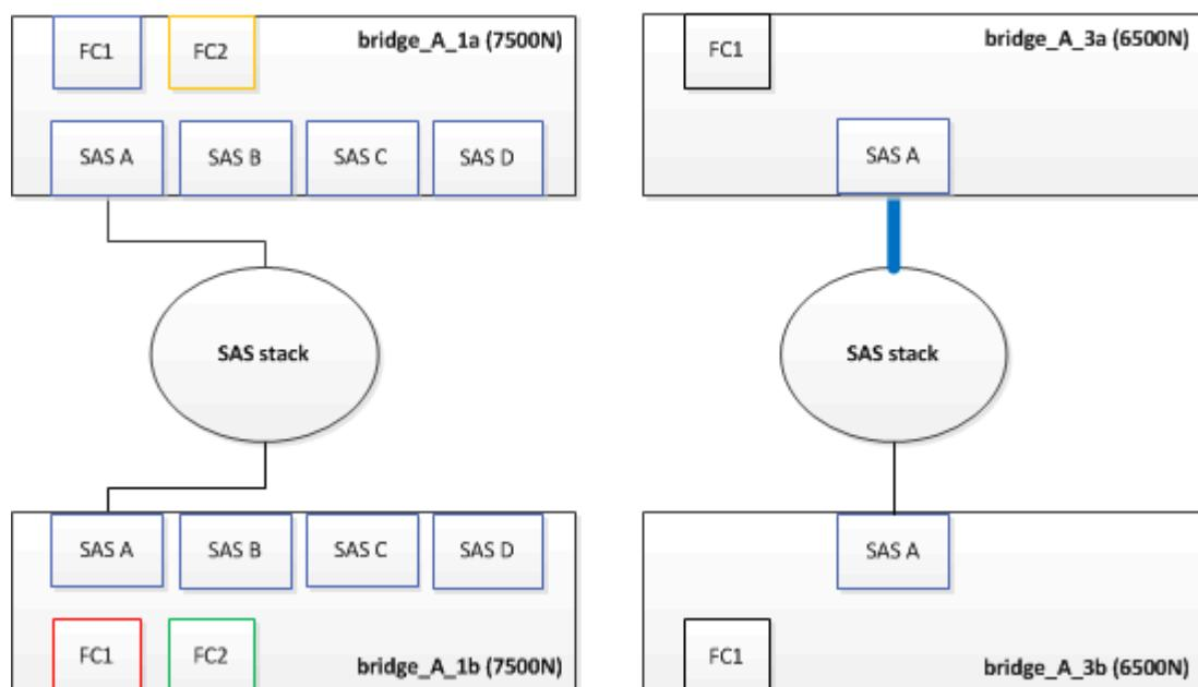
2. À l'aide d'un câble équipé d'un connecteur mini-SAS, connectez le même port SAS du shelf de stockage
