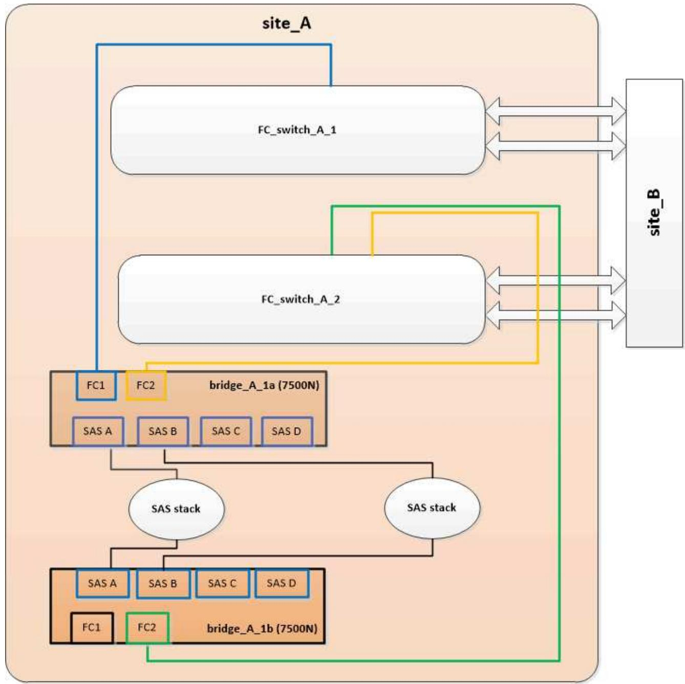
2. Reliez le port FC1 du pont inférieur au port correct du FC\_Switch\_A\_1.
