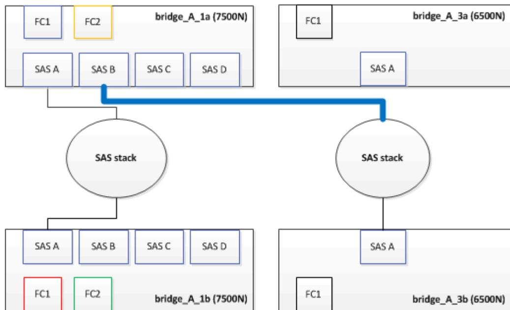
3. Retirez le câble qui connecte le port SAS A du pont Fibre Bridge 6500N inférieur au tiroir SAS supérieur, en veillant à bien noter le port SAS du tiroir de stockage auquel il est connecté.
